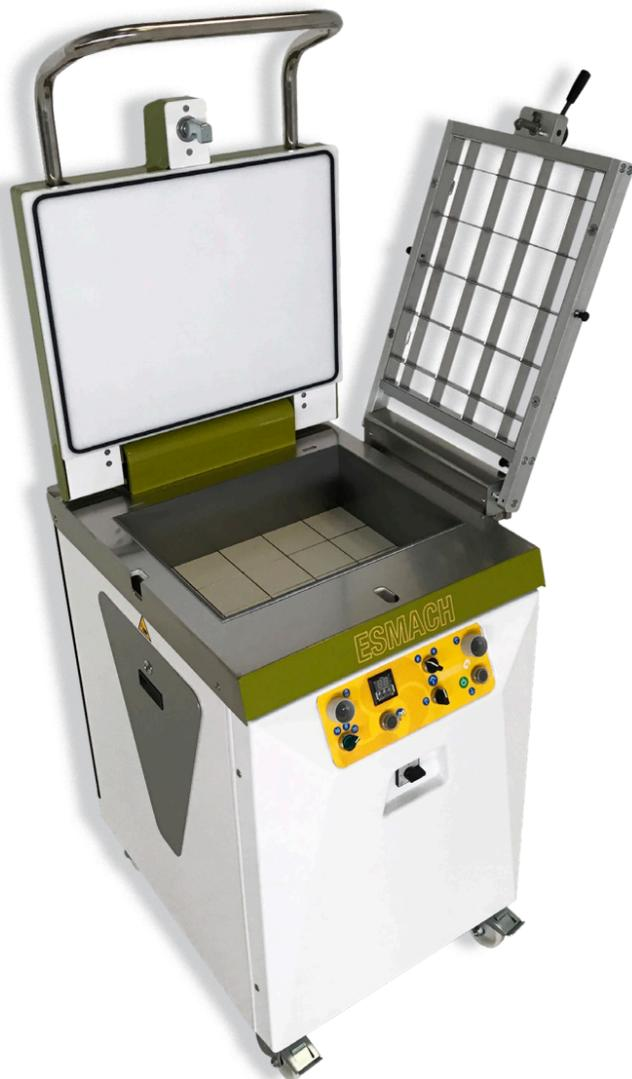
**LE PEZZATURE DVMach EVO** è una macchina automatica adatta a dividere, in una sola operazione pastoni fino a 20kg di peso in 10 - 20 pezzature di forma e peso uguale. Con l'applicazione delle apposite griglie che si applicano in modo semplice e veloce nell'apposito adattatore si possono ottenere da 10 a 80 divisioni, questo permette la realizzazione di piccoli pani, ciabatte, piccole baguettes, filoncini, triangoli.
