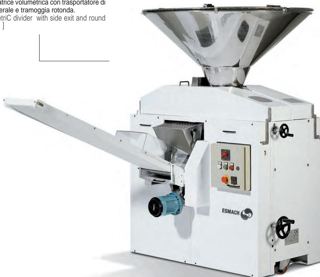
La spezzatrice volumetrica SP è una macchina concepita per dividere con precisione paste fresche o moderatamente lievitate in porzioni di peso e dimensioni variabili a seconda delle esigenze produttive e per alimentare in automatico le macchine adibite alle lavorazioni successive.
