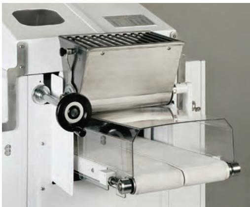
il trasportatore di uscita, frontale o laterale, è costituito da due tappeti separati la cui velocità di avanzamento può essere differenziata in modo da intercalare il prodotto quando si lavora con la macchina predisposta sulla pezzatura doppia.
