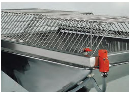
La tramoggia in acciaio inox, disponibile in formato rotondo e rettangolare, è dotata di un dispositivo di sicurezza antinfortuni, collegato elettricamente con la macchina.
