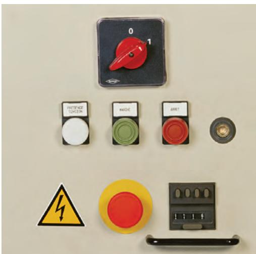
Il pannello comandi comprende un pratico dispositivo conta pezzi a preselezione che consente all'operatore di impostare il numero di pezzi da produrre. Una volta raggiunta la quantità desiderata, la spezzatrice si arresta automaticamente e, in caso di fermata intermedia, vengono evidenziate sul conta pezzi le unità mancanti al raggiungimento della quantità impostata.
