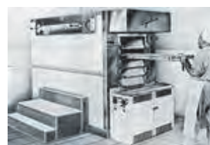
Forno con riciclo dell'aria calda « Cyclair »
