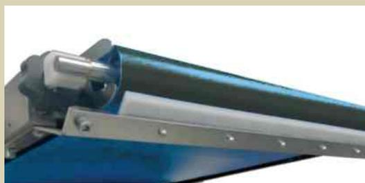
Raschiatore standard in dotazione /Standard Scraper
