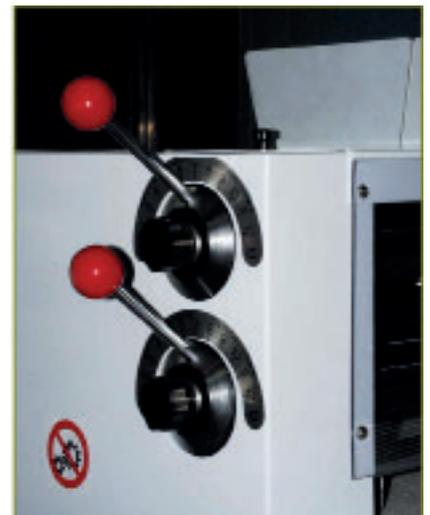
Particolare leve di regolazione dello spessore di laminazione
