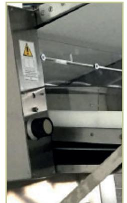
Particolare della manopola di regolazione dello spessore
