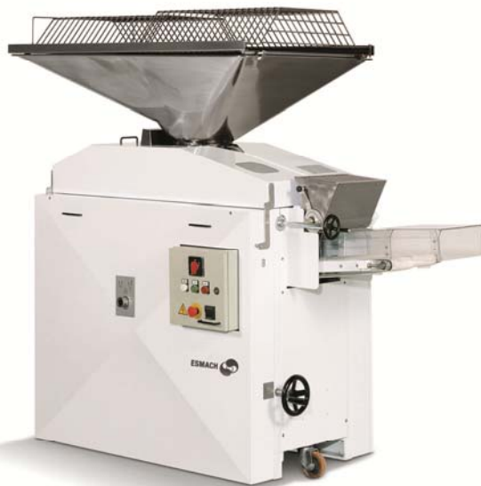
SP/1D divisora con salida frontal y tolva rectangular de 220 kg
