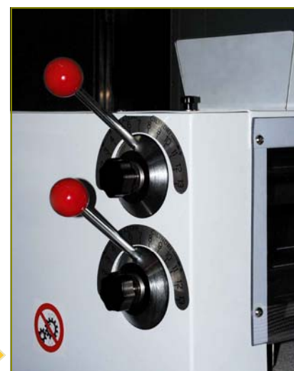
Detalle regulación del espesor de laminación
